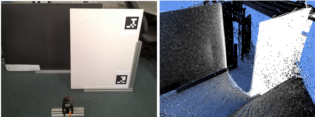
(a) Versuchsaufbau zur Messung des Lens (b) Punktwolke des Versuchsaufbaus mit resultierendem Lens Scattering Fehler
